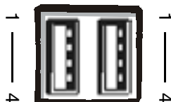
Рисунок Б-7. Номера контактов разъемов USB
